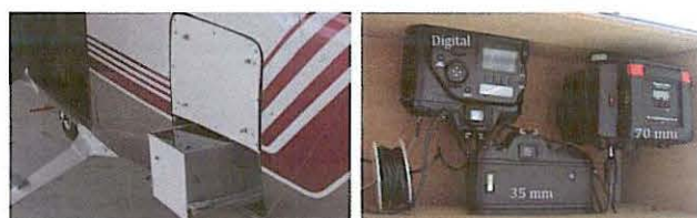
Figura 1 - À esquerda, suporte retráctil adaptado à porta posterior do avião Cessna 172 e à direita câmaras fotográficas instaladas no mesmo suporte.
